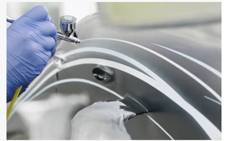
In der Boxengasse der Formel 1 ist das Team von Mercedes AMG Petronas wegen der speziellen Lackierung seiner Rennwagen einzigartig. Die Airbrush-Technik ist dabei wesentlicher Bestandteil des Lackierprozesses. Foto: Spies Hecker
