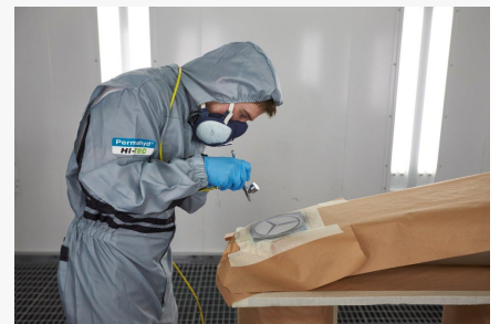
Insbesondere das Permahyd Hi-TEC System von Spies Hecker unterstützt die Fachleute im Lackierprozess. Grund: Das System ist für Mehrfarben- und Design- Lackierungen geeignet und ermöglicht das Maskieren direkt nach der Abluftzeit. Foto: Spies Hecker
