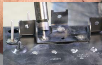
Karosserie-Stanznieten effizient und sauber entfernen
