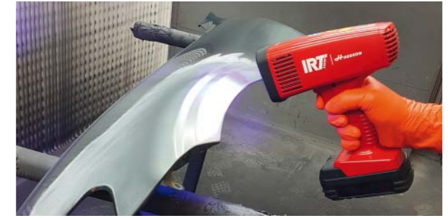
Der IRT UV SmartCure bringt eine maximale Strahlungsintensität von 350 mW/cm 2 auf den Lack.
