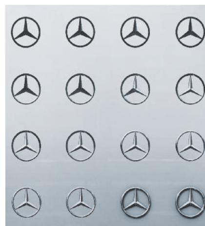
Algumas etapas do processo de 30 passos necessário à aerografia da icônica estrela Mercedes-Benz.
